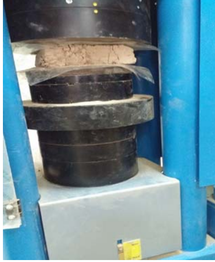
شكل رقم (٢): فحص العينات الاولية ذات مسطح كبير مقارنة بالارتفاع.
