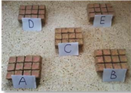
شكل رقم (١): مكعبات الطين بمقاس ٥٠×٥٠×٥٠ ملم جاهزات لفحص الضغط.
