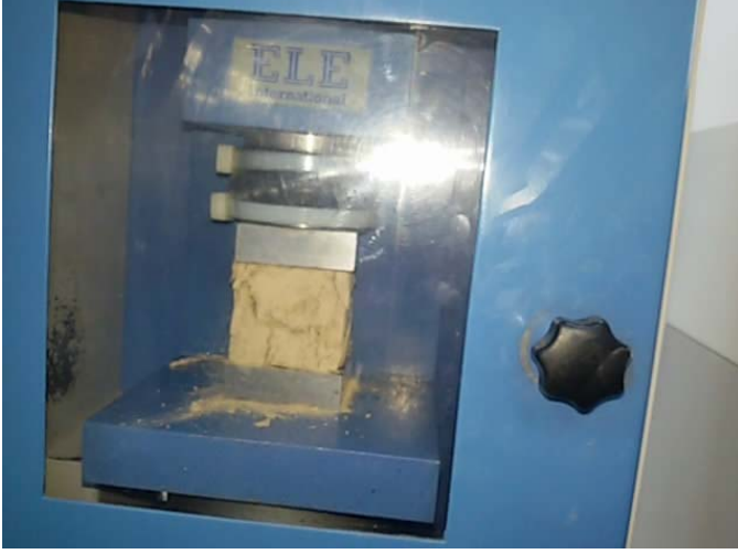
شكل رقم (٣): فحص مكعبات الطين لقياس مقاومة الضغط.
